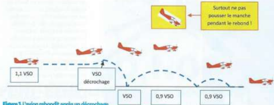
Figure 1. L'avion rebondit après un décrochage effectué trop haut (1 à 2 mètres) au-dessus du sol (vitesses indicatives).
