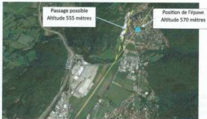
Figure 2. Report sur Google Earth de la trajectoire de décollage et de la montée initiale avec la position de l'épave. En pointillés jaunes une trajectoire permettant d'éviter le relief. Elle n'a pas été tentée par le pilote.
