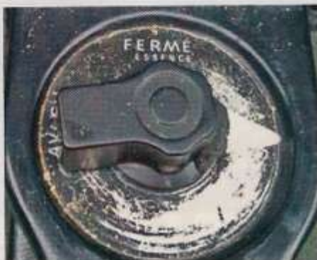
Figure 2. Si le pilote a un doute sur le réservoir en service, les indications ne lui ont été d'aucune utilité.
