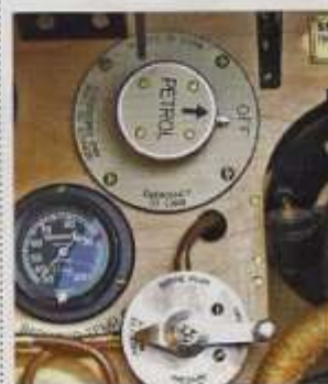
Figure 5. Le fonctionnement des sélecteurs de carburant de ce SE5 n'a rien de standard et nécessite un apprentissage spécifique comme pour la plupart des avions de collection.
