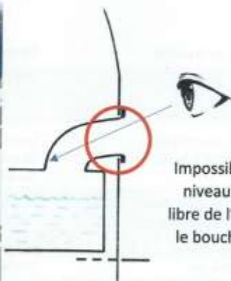
Figure 2. Impossibilité, sur le réservoir principal du DR400, d'effectuer un contrôle visuel du niveau de carburant donc de la quantité réellement embarquée (voir Info-Pilote n°741 de décembre 2017).
