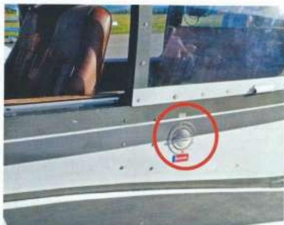
Figure 2. Impossibilité, sur le réservoir principal du DR400, d'effectuer un contrôle visuel du niveau de carburant donc de la quantité réellement embarquée (voir Info-Pilote n°741 de décembre 2017).
