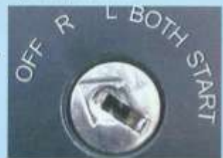
Figure 2. Type de contacteur usuel sur les avions légers. Celui de la figure est en bon état. La clé n'a pu être retirée que sur la position OFF.
