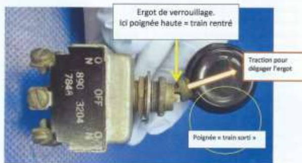
Figure 1. Type de contacteur de la plupart des avions légers à train rentrant. En l'absence d'ergot ou en cas d'usure du dispositif de verrouillage, le moindre effleurement peut manœuvrer la poignée de haut en bas ou de bas en haut.
