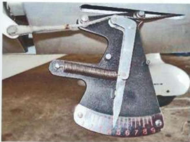
Figure 1. Contrôle de la tension sur un câble d'aileron de DR-400. Tout câble trop tendu use ses appuis (poules, passages frottants) et introduit des efforts qui nuisent à l'agrément du pilotage et même parfois provoquent des durcissements qui font penser à un blocage de commandes.
