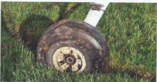
Figure 2. On se réjouirait parfois de pouvoir voler sans carénage de roue. Mais attention, s'il fait partie de la certification vous ne devez pas le démonter!
