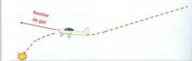
Figure 2. Arrondi effectué trop haut. La remise de gaz complète est préférable, pour un pilote moyennement entraîné, à une tentative hasardeuse de contrôle de la trajectoire aux gaz jusqu'au sol, surtout sans entraînement.
